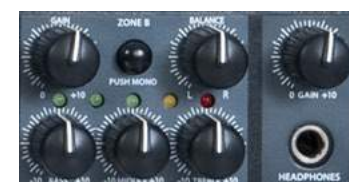
Master section with zone control and equalizer. Sección Master con control de zona y ecualizador.
